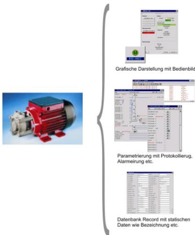
Das *Grafikobjekt* ist die grafische Abbildung des Betriebsmitteltyps auf dem Prozessbild. Das Grafikobjekt stellt die Informationen der Musterparametrierung in einer für den Bediener optimalen Form dar.
